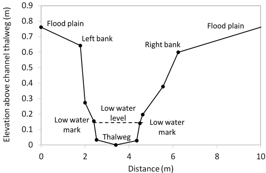
**Fig. 3.** Schematic diagram for a survey of a typical cross section.[Title Page](#)[Abstract](#)[Introduction](#)[Conclusions](#)[References](#)[Tables](#)[Figures](#)[⏪](#)[⏩](#)[◀](#)[▶](#)[Back](#)[Close](#)[Full Screen / Esc](#)[Printer-friendly Version](#)[Interactive Discussion](#)
